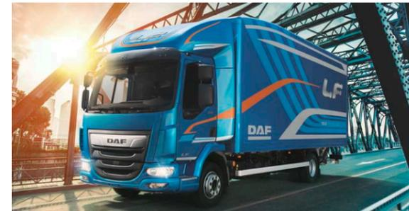
Wenn Sie einen Kofferaufbau für den DAF LF bestellen, sollten Sie den „Aerobody“ in Betracht ziehen. Sein aerodynamisches Design macht ihn bei einer Geschwindigkeit von 85 km/h bis zu 8 Prozent effizienter, was auch die CO<sub>2</sub>-Emissionen um 8 Prozent reduziert.
