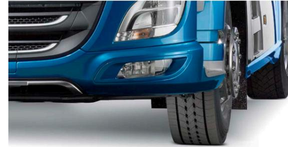
Der richtige Reifendruck verbessert den Rollwiderstand und spart ebenfalls Kraftstoff. Ein um 20 Prozent zu niedriger Reifendruck für einen Sattelzug kann den Rollwiderstand um 8 Prozent und den Kraftstoffverbrauch um 2,5 Prozent erhöhen, was dann auch 2,5 Prozent höhere CO<sub>2</sub>-Emissionen bedeutet.
